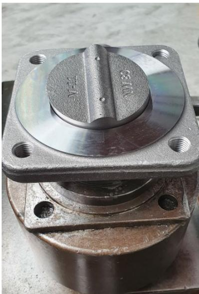
12. Mit zwei ganz leichten Hammerschlägen, zuerst oben dann unten, gleichmäßig in den Innendurchmesser des Flansches ansetzen
